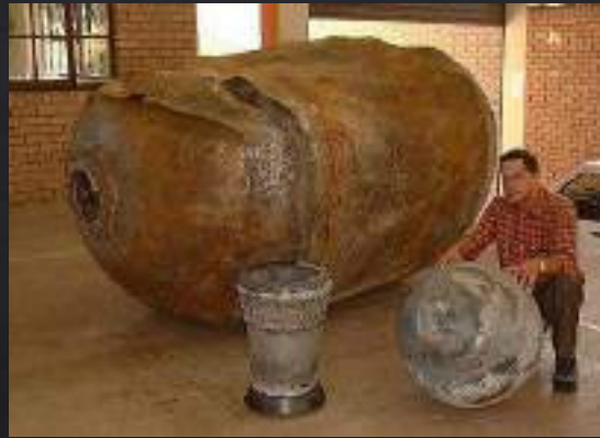
Réservoirs et tuyère du deuxième étage d'une fusée Delta II retrouvé en Afrique du Sud en 2000.
