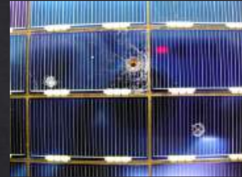
Impacts sur les panneaux solaires du télescope spatial Hubble
