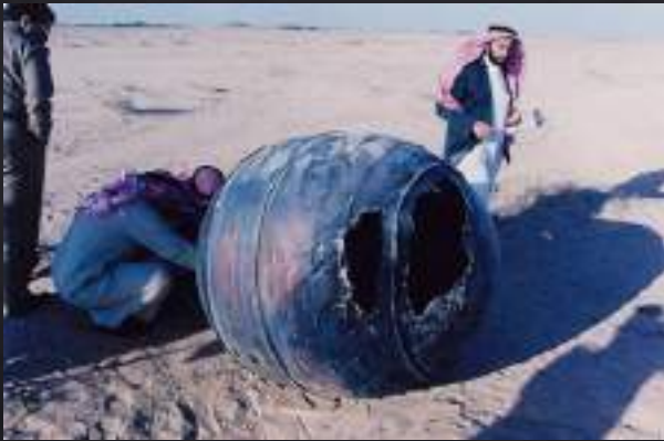
Enveloppe en titane (70 kg) du moteur du troisième étage de la fusée Delta 2 après son impact au sol en Arabie Saoudite le 21 janvier 2001 (source Nasa)
