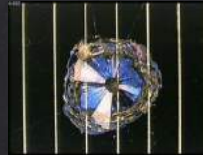
Impacts sur les panneaux solaires du télescope spatial Hubble
