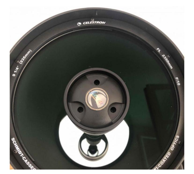
Il va nous falloir prendre un repère sur le télescope pour le choix des vis à tourner.
